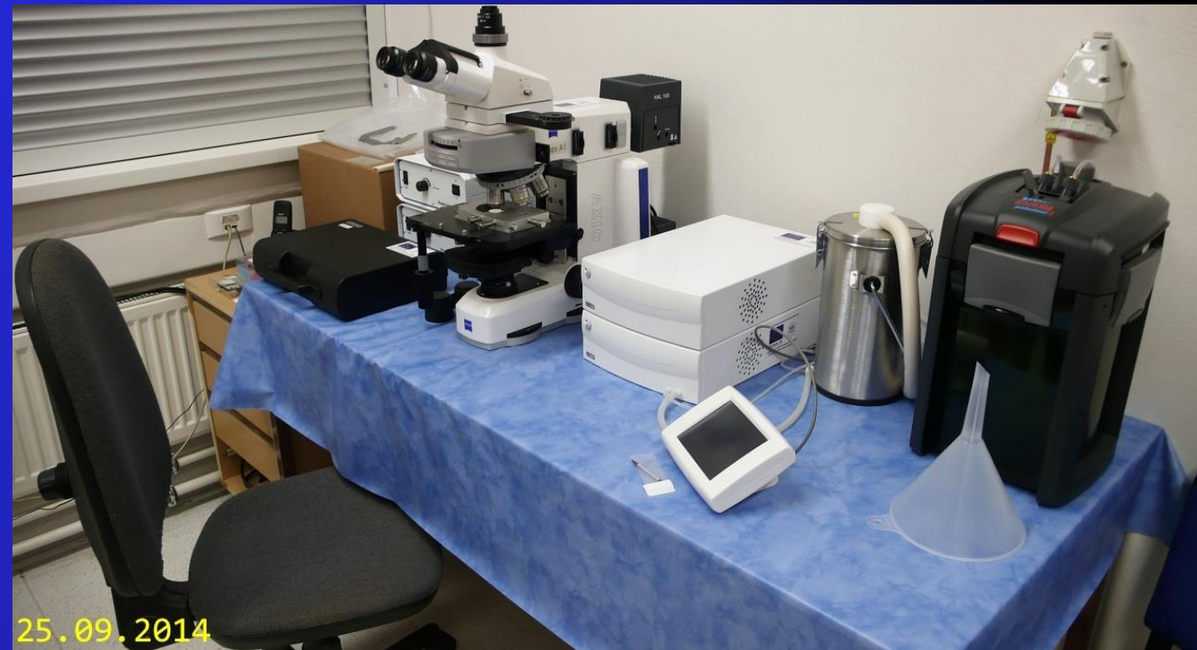
Mikroskop ZEISS AxioScope.A1 s termokrymetrickou komorou Linkam FTIR600 Fluidné inklúzie
