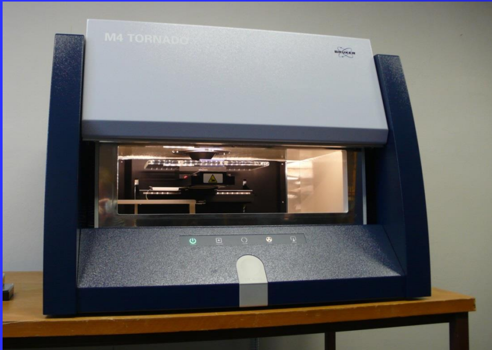
\mu -EDXRF spektrometer M4 TORNADO (Bruker) Chemická mikroanalýza a kompozičné mapovanie
