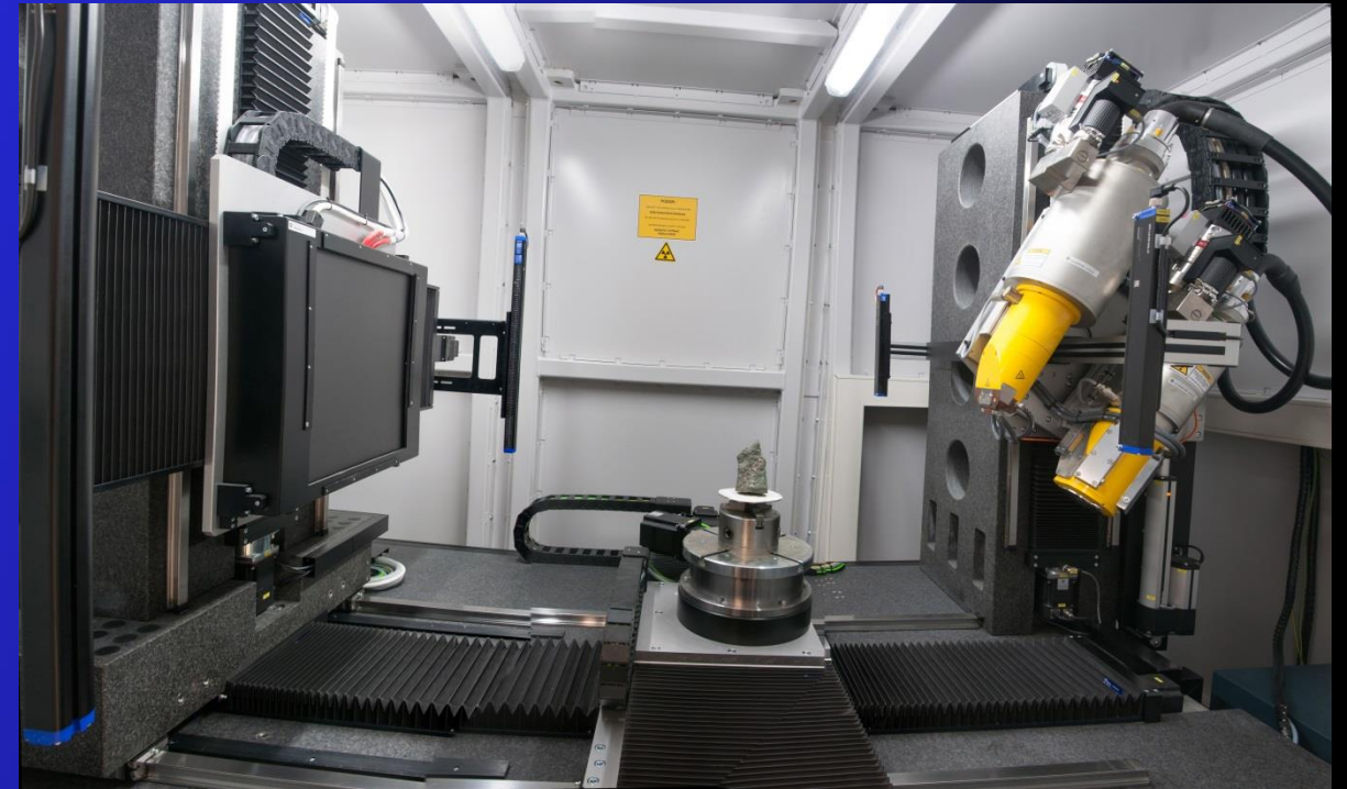
Mikrotomograf Phoenix v|tome|x L 240 (General Electric) Nedeštruktívna 3D analýza
